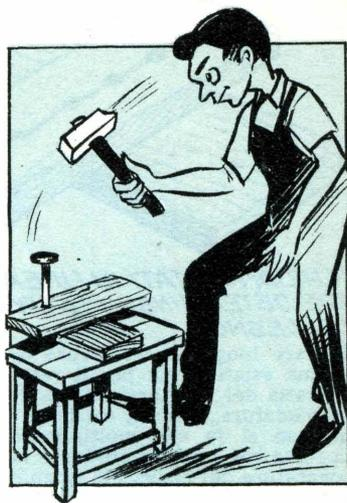
la forza di aderenza è superata ed il legname si spacca secondo una delle linee di minore resistenza. Tali linee di minor resistenza hanno sempre una direzione identica a quella della venatura del legno, ne deriva che il chiodo, trovandosi a non avere alcuna forza che contrasti lo ulteriore spostamento di fibre lungo che la sua entrata nel blocco ha causato, fallisce il suo scopo.
